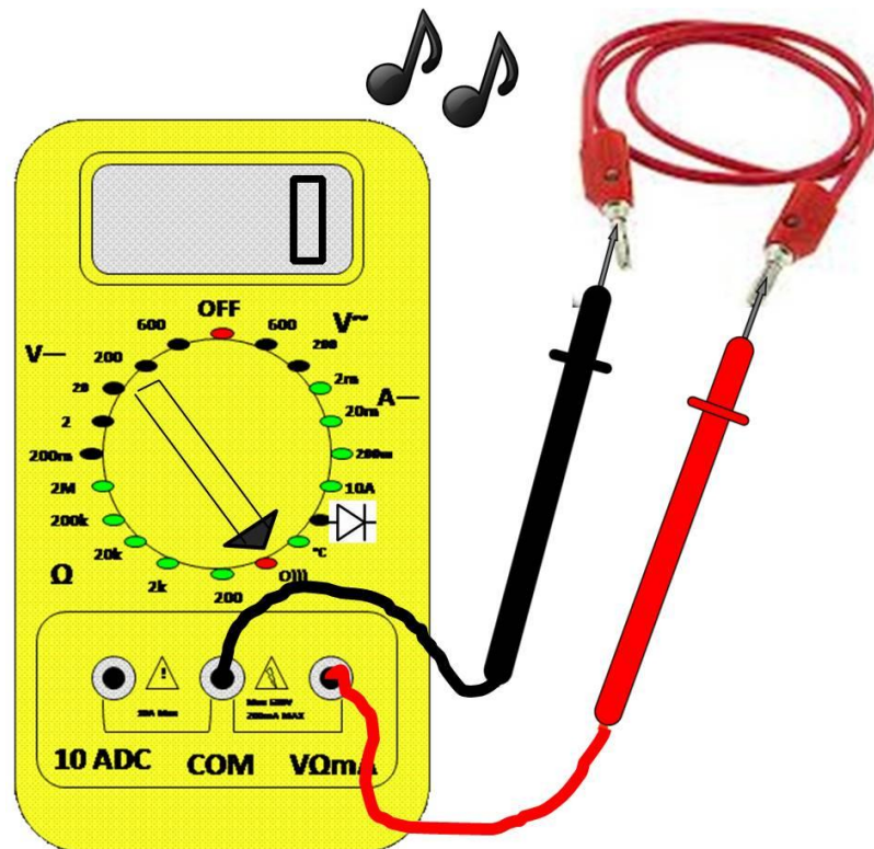
รูปที่ 3.11 การวัดความต่อเนื่องของสายไฟฟ้า
