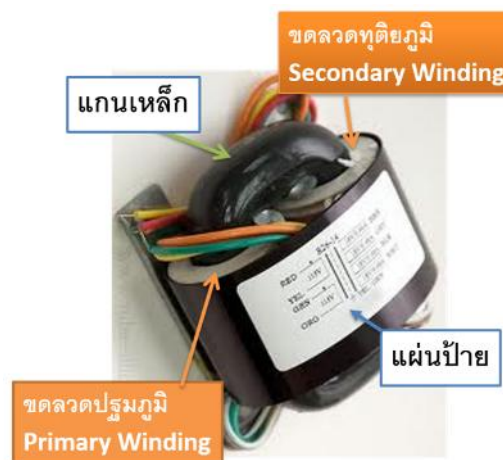
รูปที่ 1.3 ขดลวดและแกนเหล็กของหม้อแปลงไฟฟ้า
