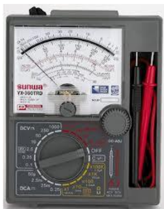
รูปที่ 2.2 มัลติมิเตอร์ซันวา รุ่น YX-360TRD (ผลิตภัณฑ์ : SANWA Electric Instrument)
