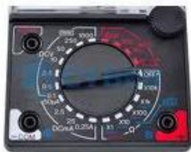
รูปที่ 2.4 สวิตช์เลือกพิสัยการวัดของ มัลติมิเตอร์รุ่น YX-360TRD
