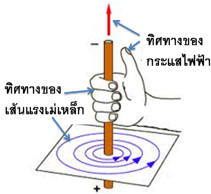
รูปที่ 2-2 การเกิดเส้นแรงแม่เหล็กรอบ ๆ ตัวนำไฟฟ้า ที่มีกระแสไฟฟ้าไหลผ่าน
