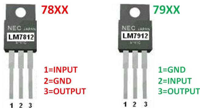
รูปที่ 7.3 การจัดวางขาของไอ.ซี.เร็กกูเลเตอร์ อนุกรม 78xx และ 79xx
